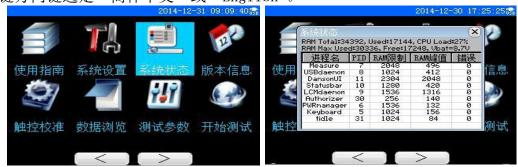
8. 回到主菜单界面,按【▲】【▼】【〈】【〉】键,移动光标到"系统状 态",按【OK】键,仪器显示当前系统的状态,按【ESC】键,返回到主菜单;
