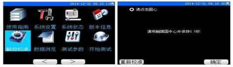
回到主菜单界面,按【▲】【▼】【〈】【〉】键,移动光标到"触 控校准",按【OK】键,进入校准界面,请点击圆心并保持0.5秒,按【确 定】键,返回到主菜单;
