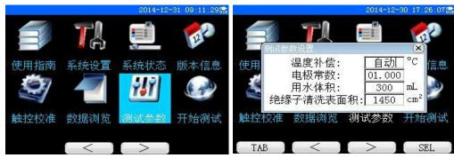
回到主菜单界面,按【▲】【▼】【〈】【〉】键移动光标到"测试参数",按【OK】 键进入"测试参数设置"界面;
